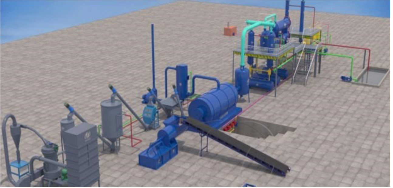
ŞEKİL 3.17. Piroлиз Tesisi Örnek Gösterim Şeması
